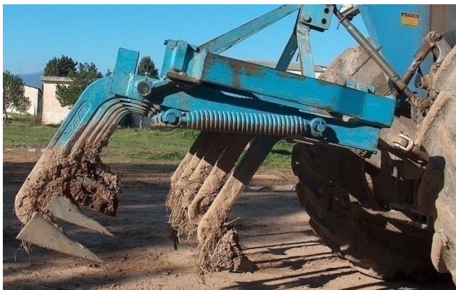
Décompacteur - Source : Giancarlo Dessì, licence CC BY-SA 3.0
